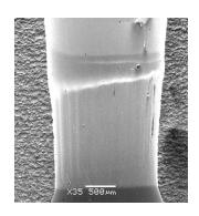
环沟:对使用后的拉伸模 观察发现,有80%以上的拉伸模工作区的入口端,通常有一道磨损得比其它部位更加严重得环形沟槽,拉丝行业称之为环沟。
