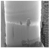
在拉伸模工作区钢丝与膜壁首先接触的位置上方,牢固的粘附着面积大小不一的金属片,即为"焊合"现象
